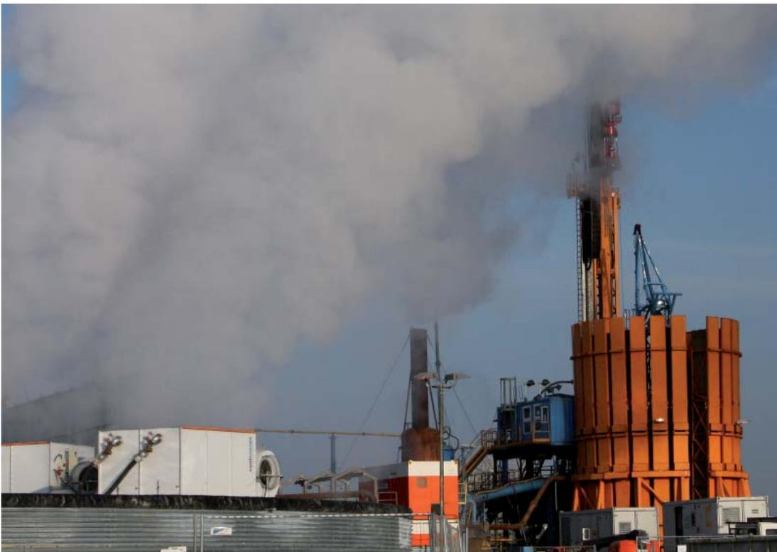
Abb. 43: Pumpversuch in der Bohrung Unterföhring TH 4 (© GEOVOL Unterföhring GmbH)
