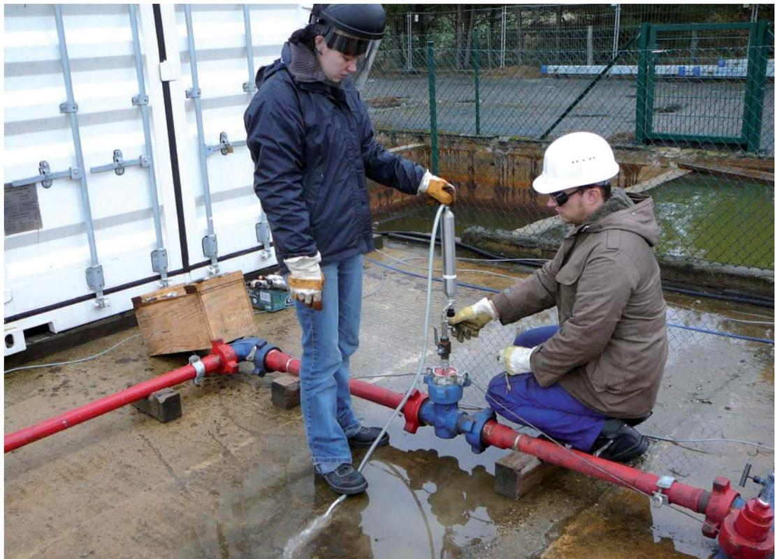
Abb. 20: Fluidprobenahme zur Bestimmung der Wasser- und Gaszusammensetzung an der Bohrung Horstberg
