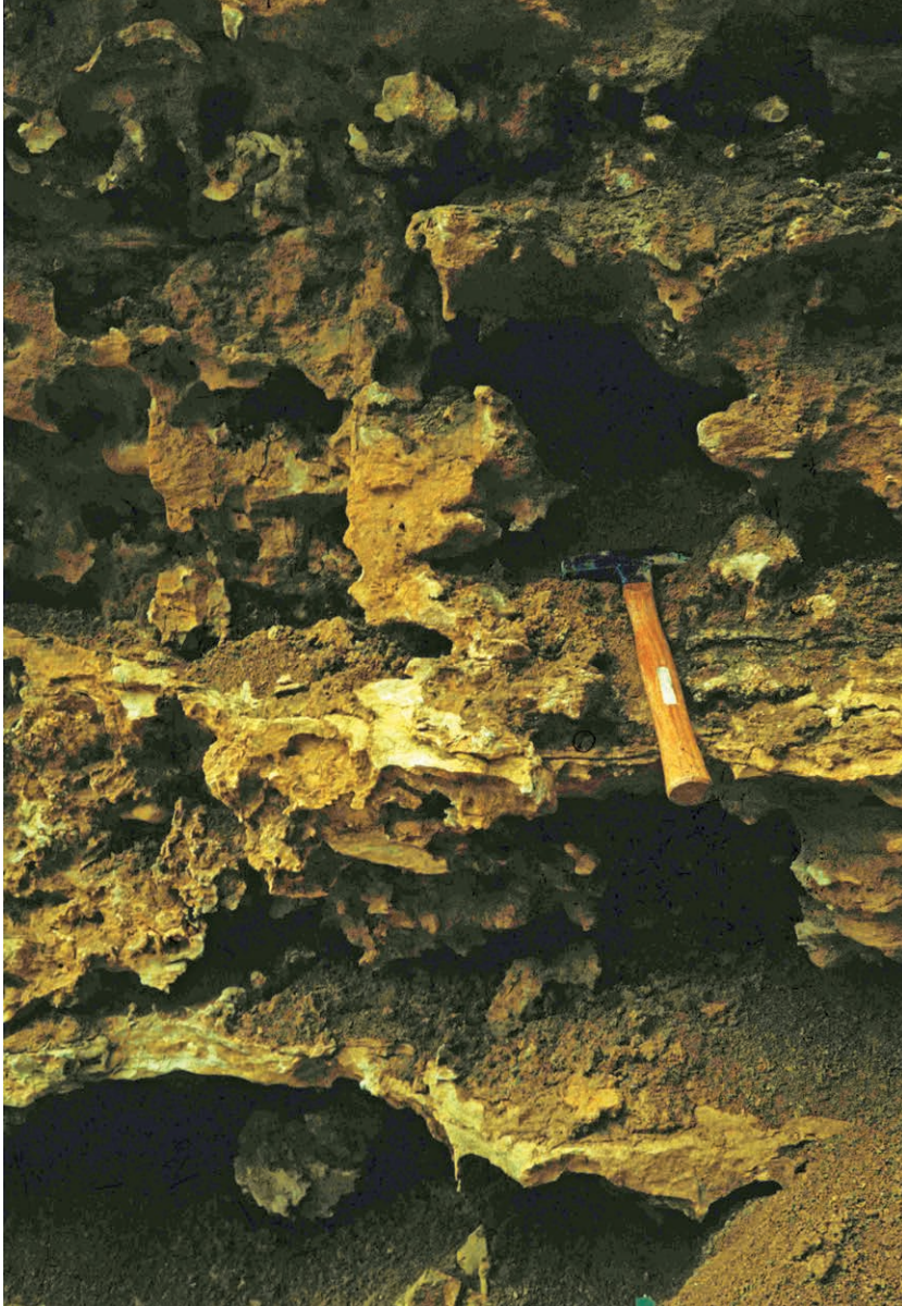
Fig. 3: Jurásico Superior cavernoso (Malm): ejemplo de un acuífero con permeabilidad muy alta
