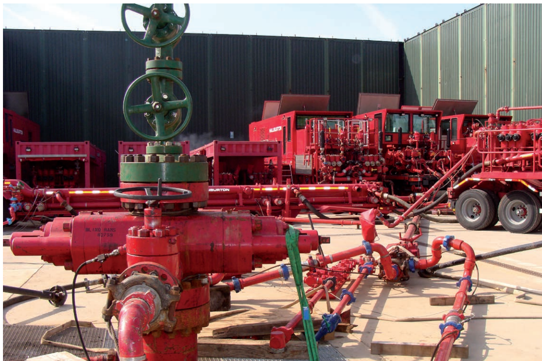
Fig. 15: Instalación de bombeo durante un tratamiento de fracturamiento (frac test)
